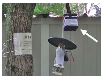
図 2. 蚊捕集用 CO 2 トラップ 矢印はドライアイスを入れた保冷容器
