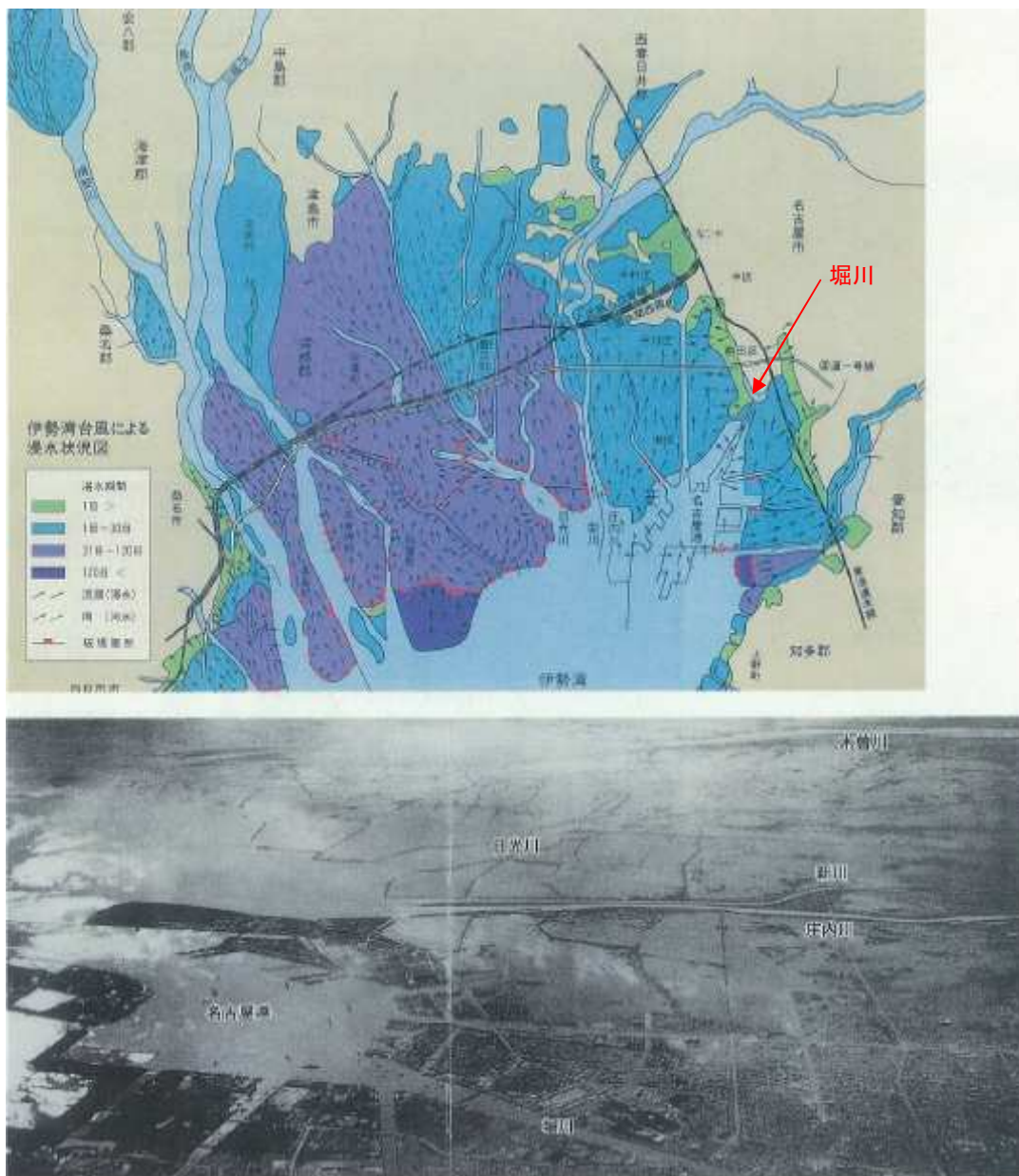
図-1.10 伊勢湾台風による湾奥部破壊箇所と浸水状況図
