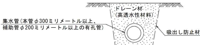
図 3-6 暗渠排水工の基本構造
