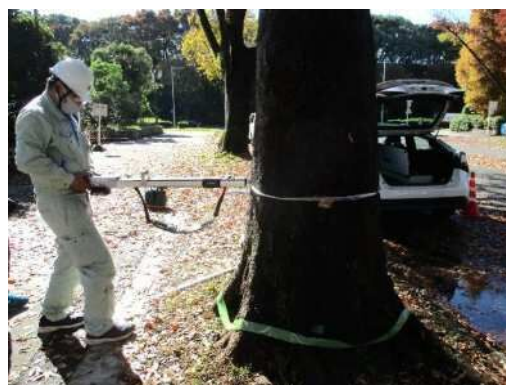
貫入試験による腐朽度の調査
