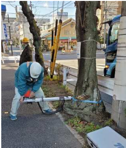
【撤去前】ソメイヨシノ 貫入試験による腐朽度の調査
