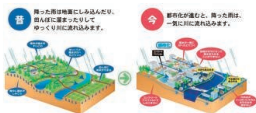
都市化の進展による浸水被害の危険性
