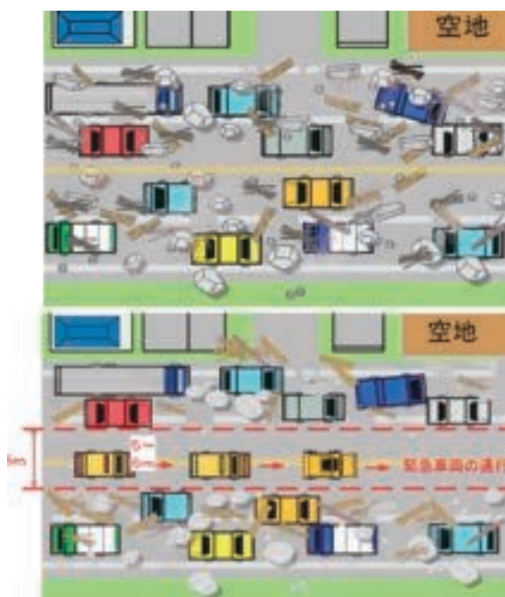
道路啓開作業のイメージ
