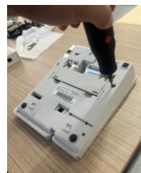
貸し出している電動ドライバーにてネジをはずしていきます。
