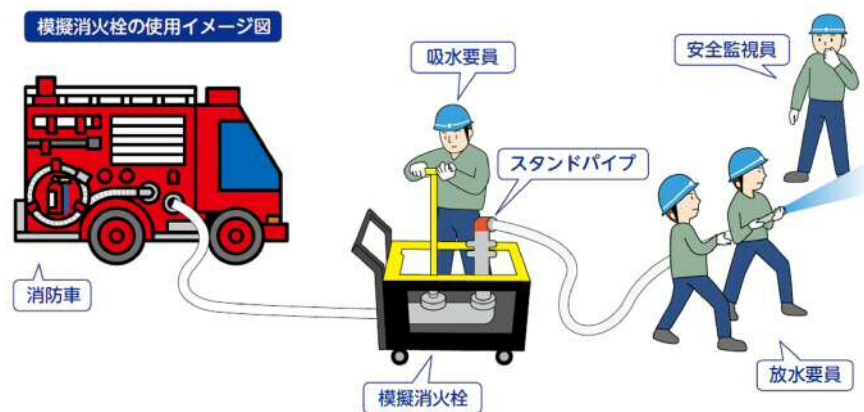
図 2. 2. 4 模擬消火栓を使用したスタンドパイプの消火訓練イメージ
