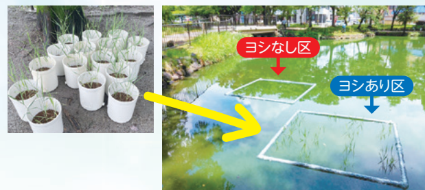
図4 水質浄化実験の様子(南区道徳公園内の月見池にて)
