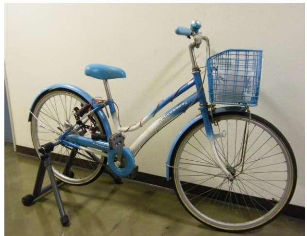
図 1 自転車発電・省エネ電球体験装置
