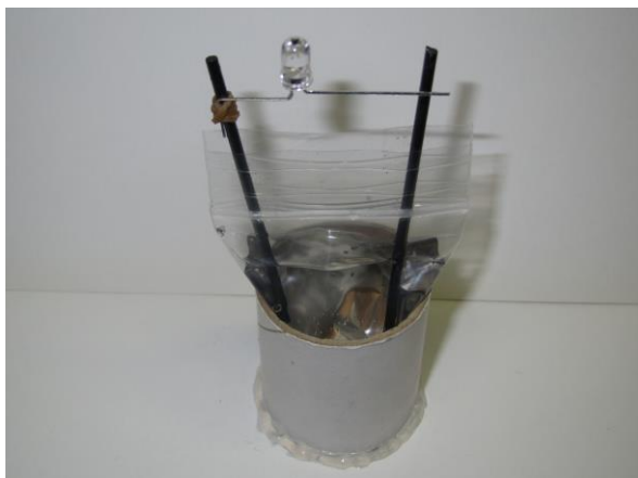
図7 完成したえんぴつ電池
