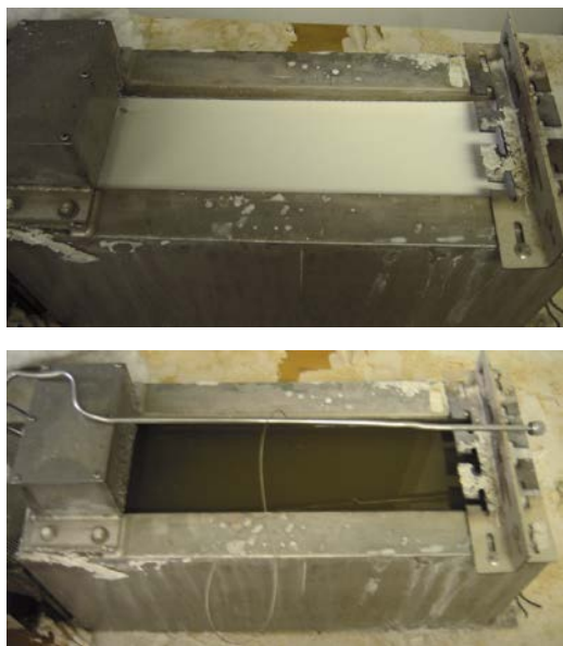
図2 ソルトバス（上段：非加熱時，下段：加熱時）
