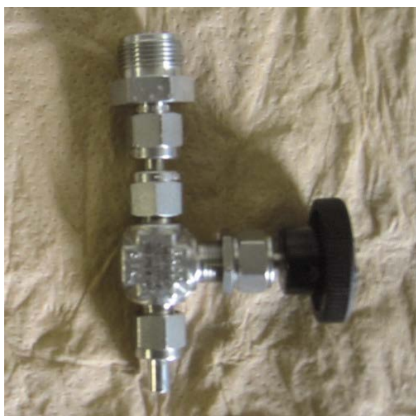
図3 ガス採取用吹き出し口及びバルブ
