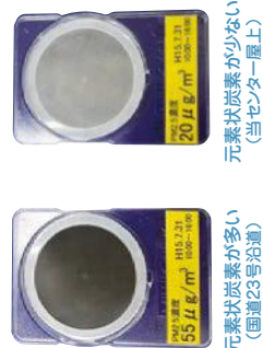
図3 PM2.5を採取したろ紙(平成15年度)
