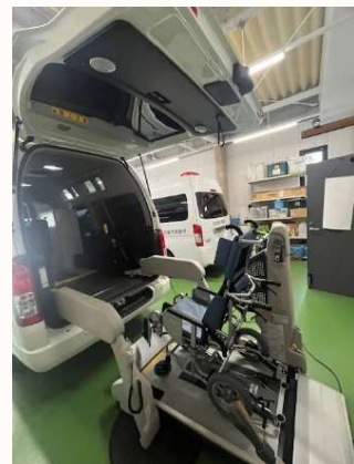
電動リフトにより車椅子を車内へ挙上
