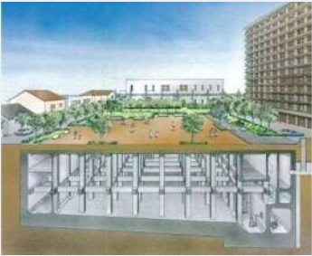
高辻雨水滞水池
