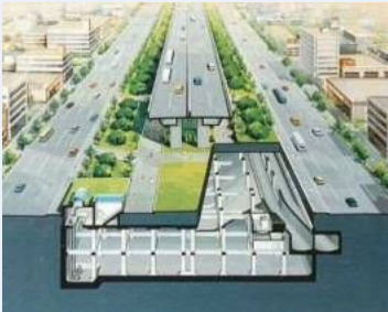
若宮大通調節池
