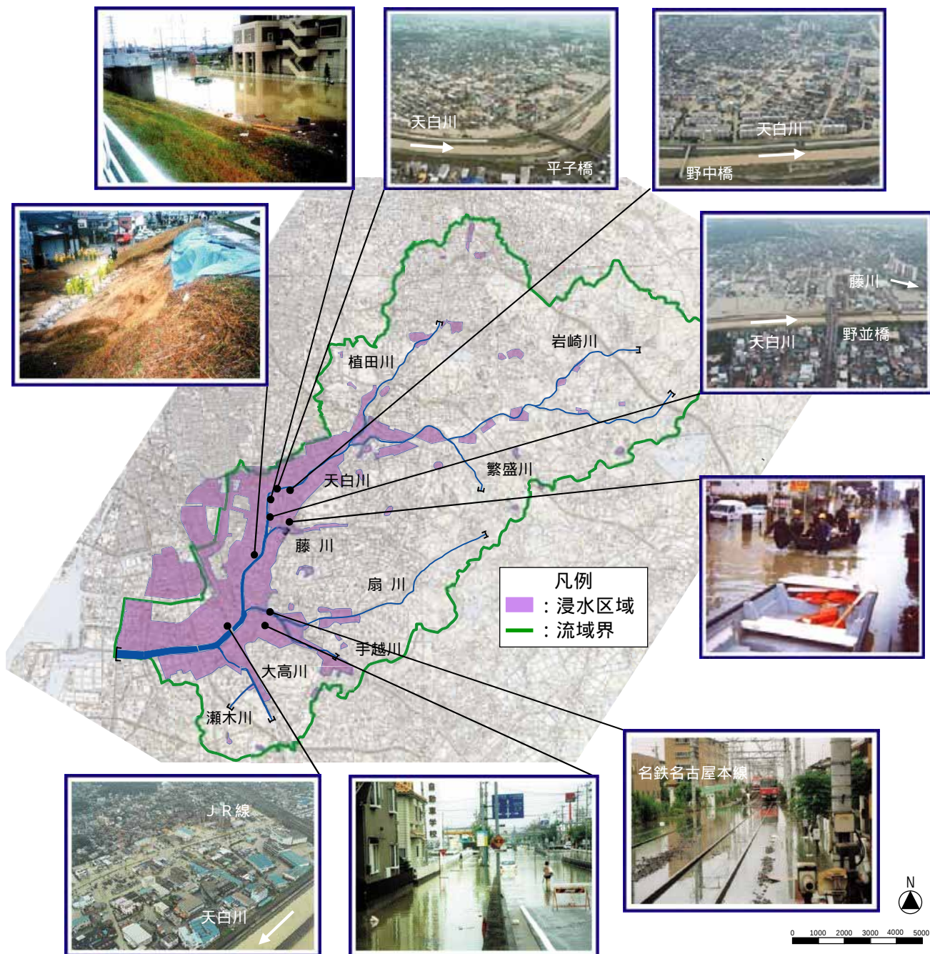
図 - 5 浸水区域および被害状況写真【平成 12 年 台風 14 号（東海豪雨）】
