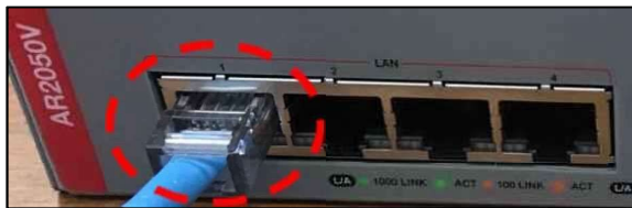
無線ルータ (LANポート)
