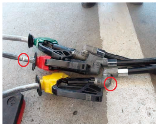
↑ 破損したノズル
