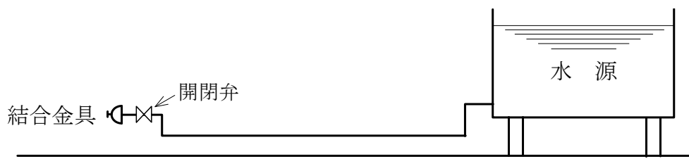
第17-1図 a 地上式の水源を有する消防用水
