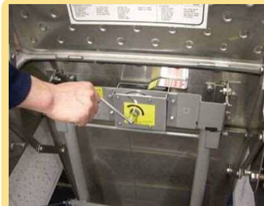
② 備え付けのハンドルで、矢印方向に回し、はしごを引き上げる
