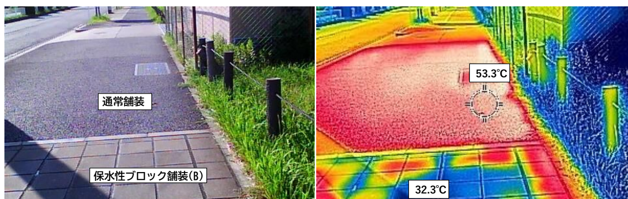
保水性ブロック舗装（B）の写真（左）とサーモカメラ画像（右）
