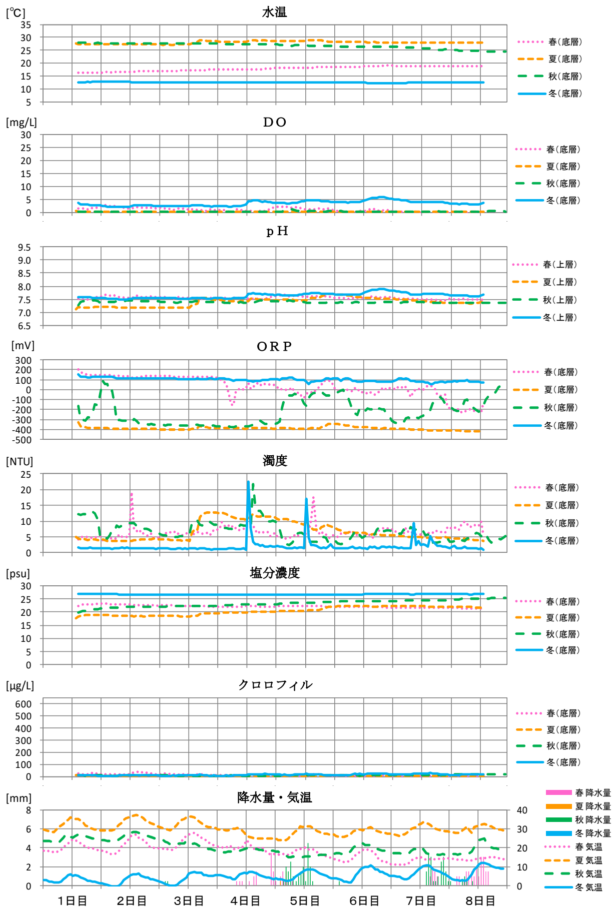
図 3-15 中川運河東海橋の四季の測定結果（底層_グラフ）
