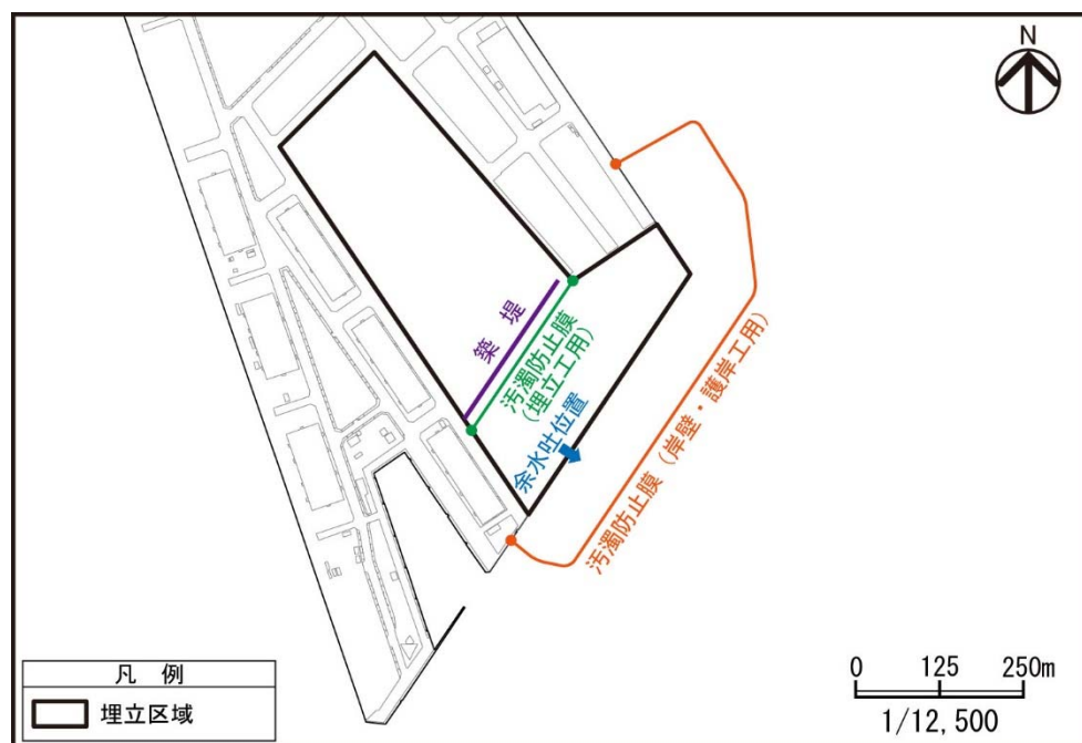
図 1-2-15 築堤、余水吐及び汚濁防止膜の位置
