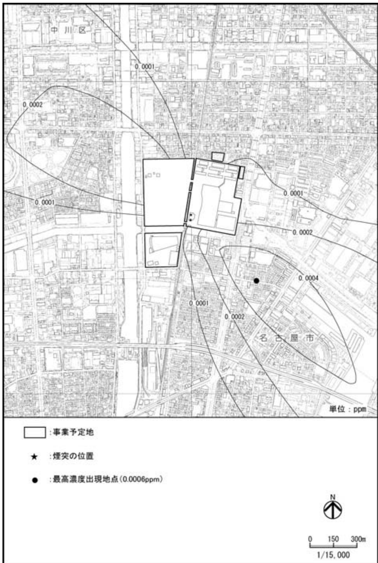
図 2-1-19(1) 熱源施設の稼働による二酸化窒素濃度の予測結果（1 期工事完了後）
