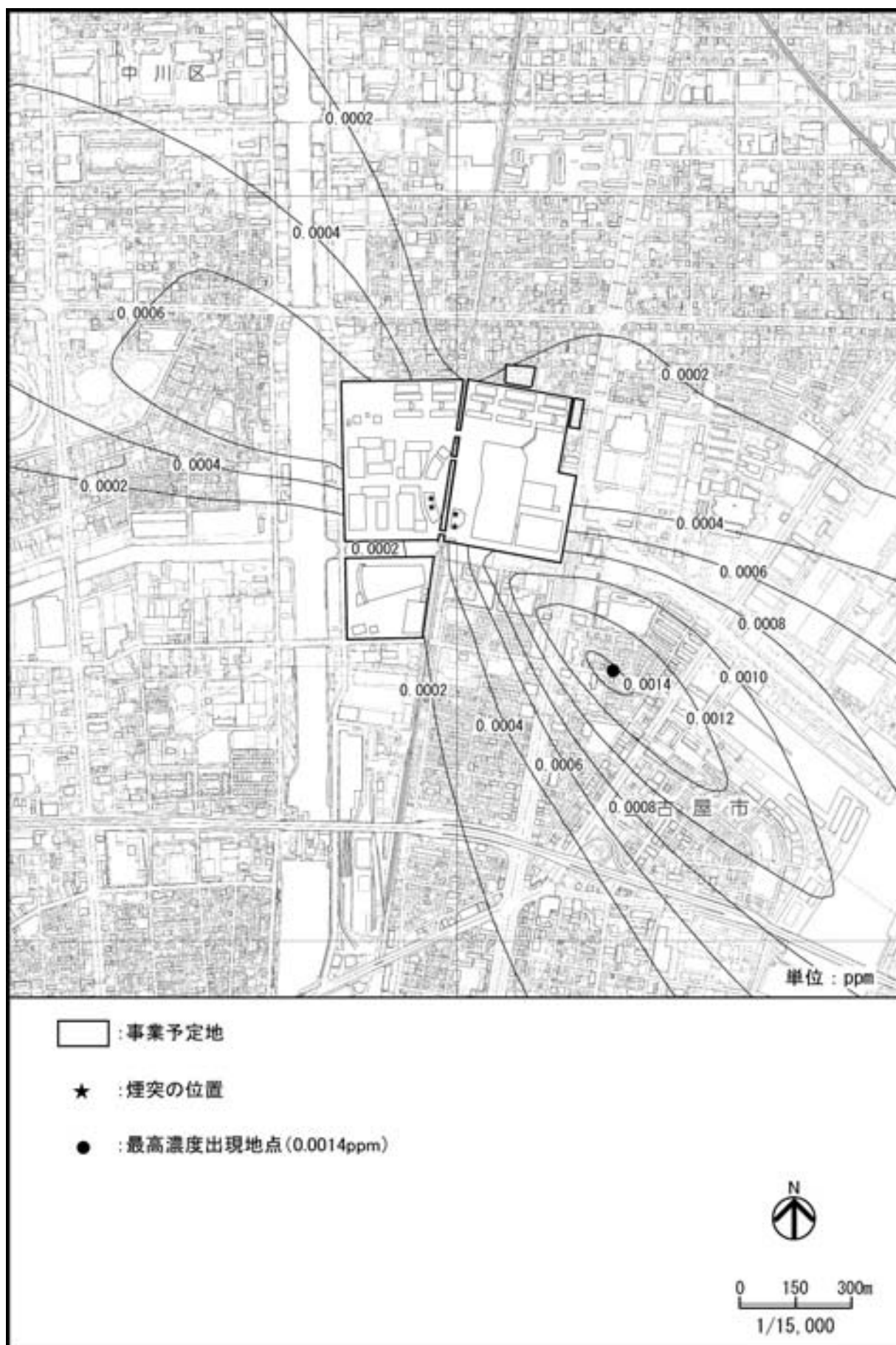
図 2-1-19(2) 熱源施設の稼働による二酸化窒素濃度の予測結果 (2 期工事完了後)
