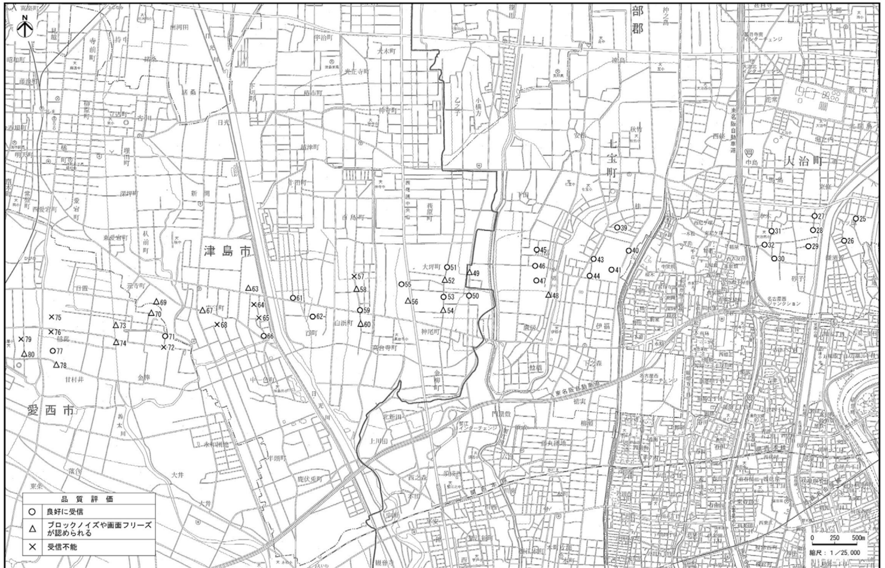
図 - 1 (2) 名駅局における地上デジタル放送電波の受信品質評価（名古屋市内外）
