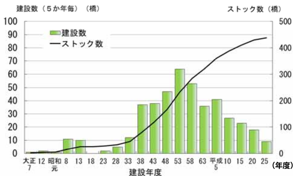
重要橋りょうの建設年度
