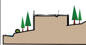
改変面積を小さくするため、盛土斜面を垂直なよう壁構造にしている
