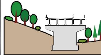
小動物の移動経路とみずみちの確保を図るため、谷底部や沢筋は橋りょう構造にしている
