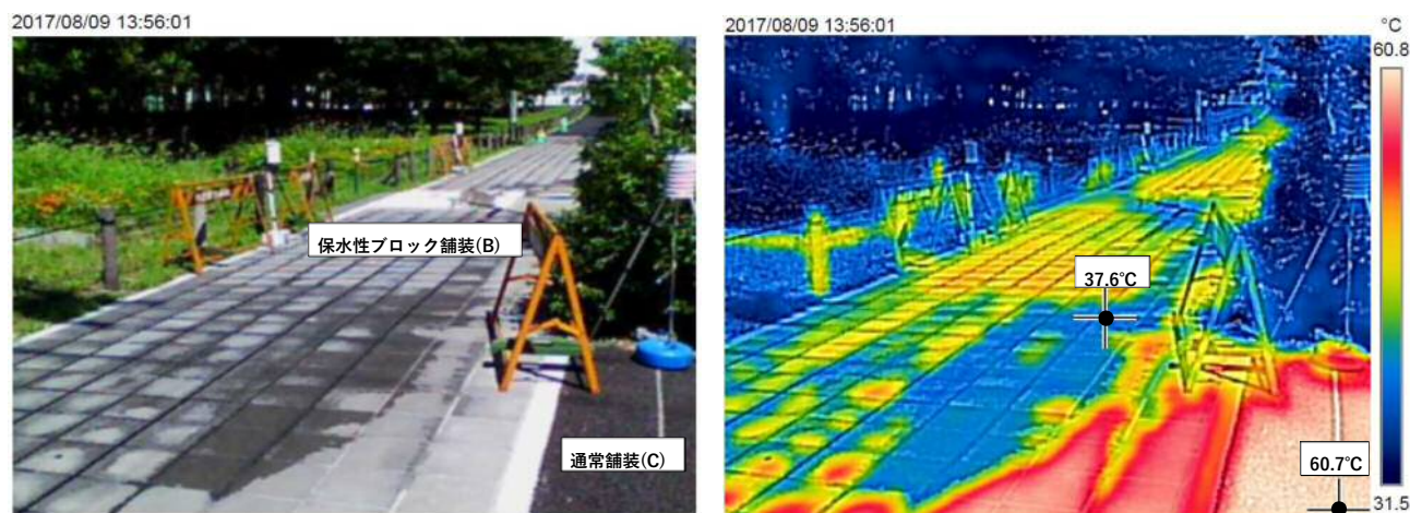
保水性ブロック舗装（B）の写真（左）とサーモカメラ画像（右）
