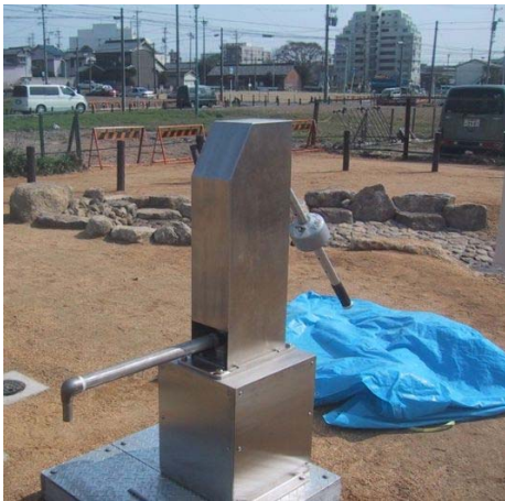
手押しポンプを備えた井戸
