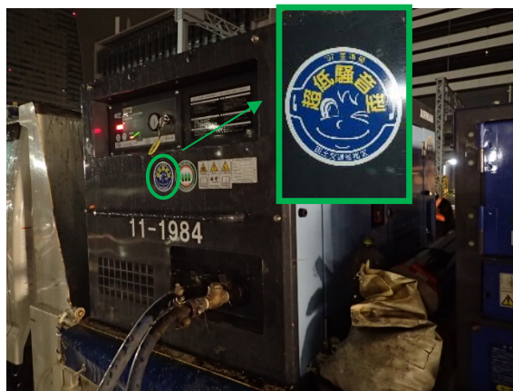
写真 7-1-3-3 低騒音型建設機械の採用
