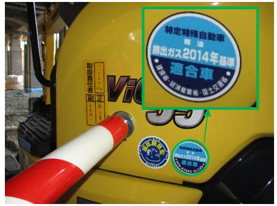
写真 7-1-3-2 排出ガス対策型建設機械の採用
