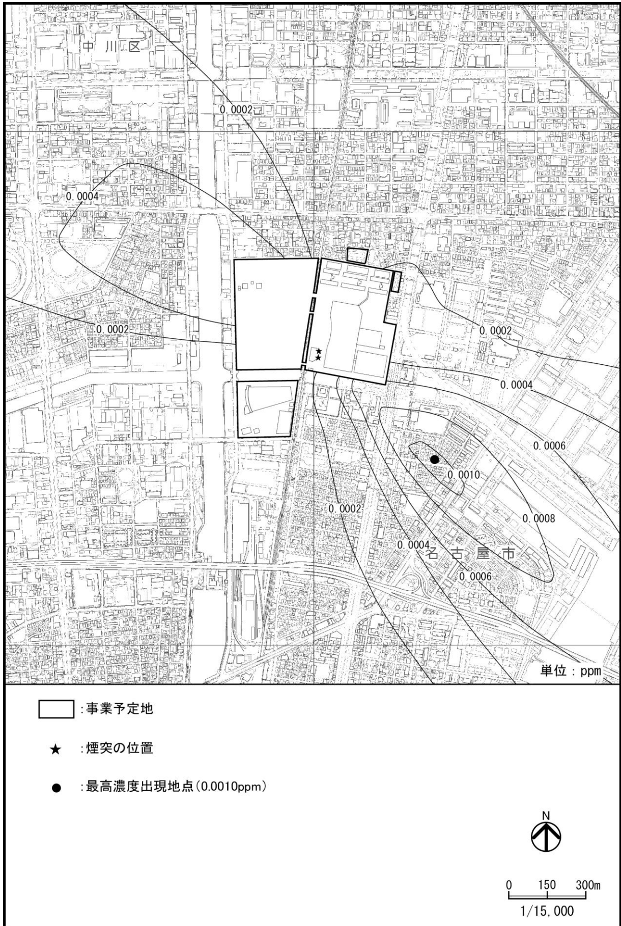
図3-1-2(1) 熱源施設の稼働による二酸化窒素濃度の予測結果(1期工事完了後)(変更前)
