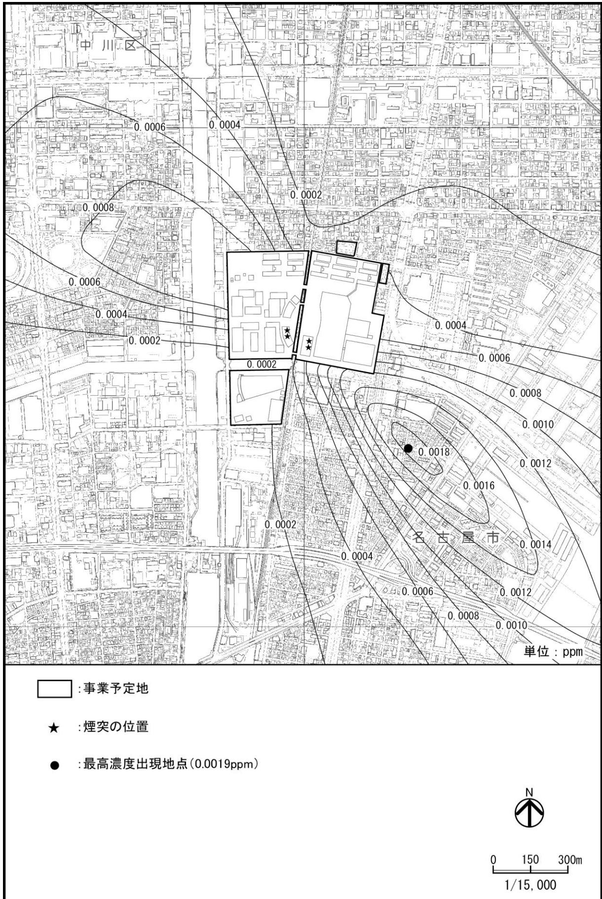
図3-1-2(3) 熱源施設の稼働による二酸化窒素濃度の予測結果(2期工事完了後)(変更前)
