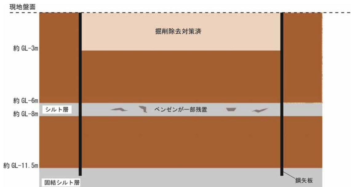
図 2-6-3 鋼矢板で囲い込んだ範囲における現在のベンゼン残置の断面イメージ図
