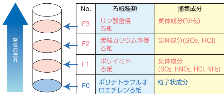
図1-1 フィルターパック法の捕集装置(模式図)
