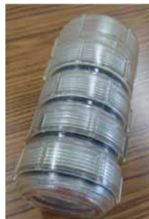
図1-2 フィルターパック法の捕集装置(写真) 黒い部分に、それぞれのろ紙(F0~F3)がセットされる
