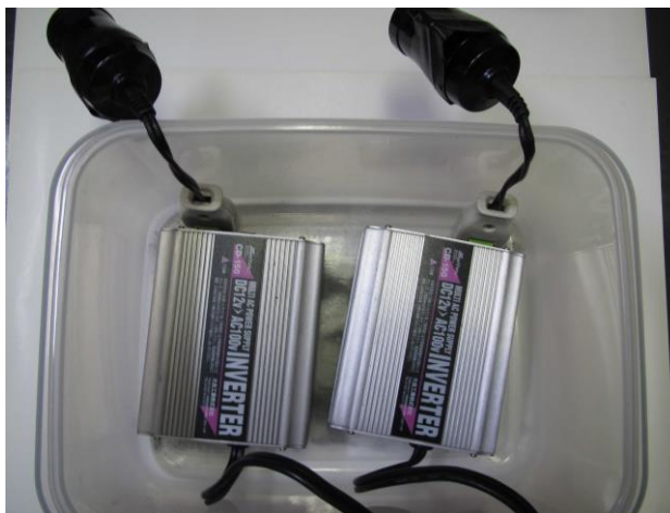
図5 放電部：インバータ及び電球ソケット
