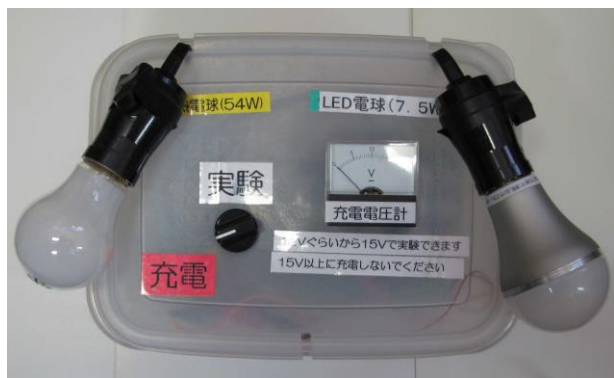
図6 制御部：切り替えスイッチ及び電圧計
