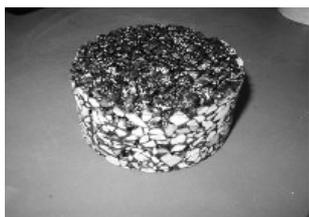
Fig.2 排水性舗装コアサンプル例
