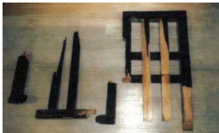
有松祭りで見られる神功皇后車の輪掛けの修復[平成25年度](左2枚:修理前、右:修理後)
