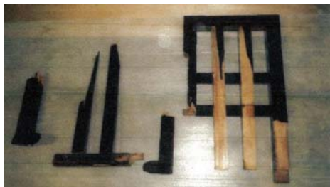
有松祭りで曳かれる神功皇后車の輪掛けの修復[平成25年度](左2枚:修理前、右:修理後)
