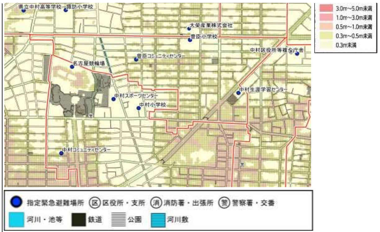
(5) 内水氾濫浸水継続時間（内水氾濫時に50cm以上の浸水が継続する時間）
